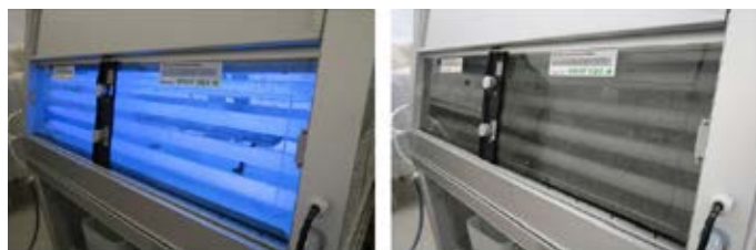
Obr. 7 Pohľad na prístroj QUV (vľavo UV perióda, vpravo vlhkosťná perióda)
