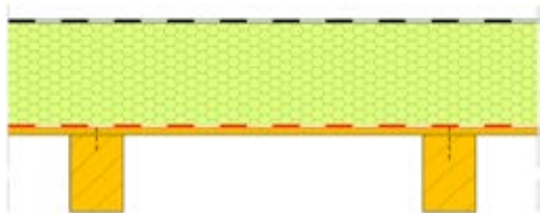
Obr. 3 Ukážka vhodného riešenia skladby jednoplášťovej plochej strechy s priznanými drevenými prvkami v interiéri
